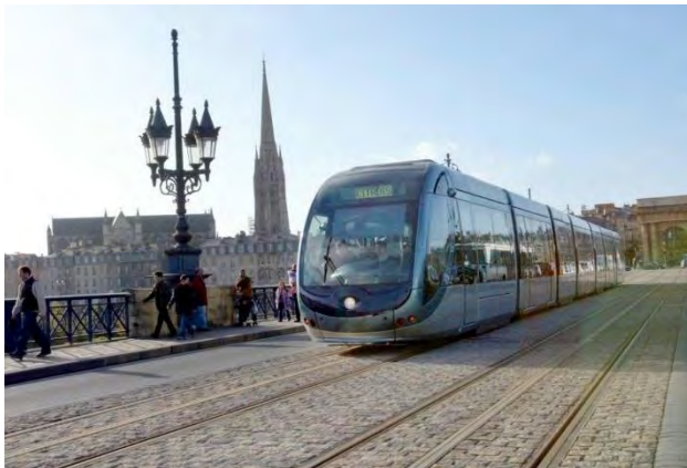
Bordeaux 2003. APS* (3ème rail enterré)
