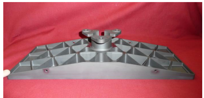
Fig. 5. M1 mirror blank
